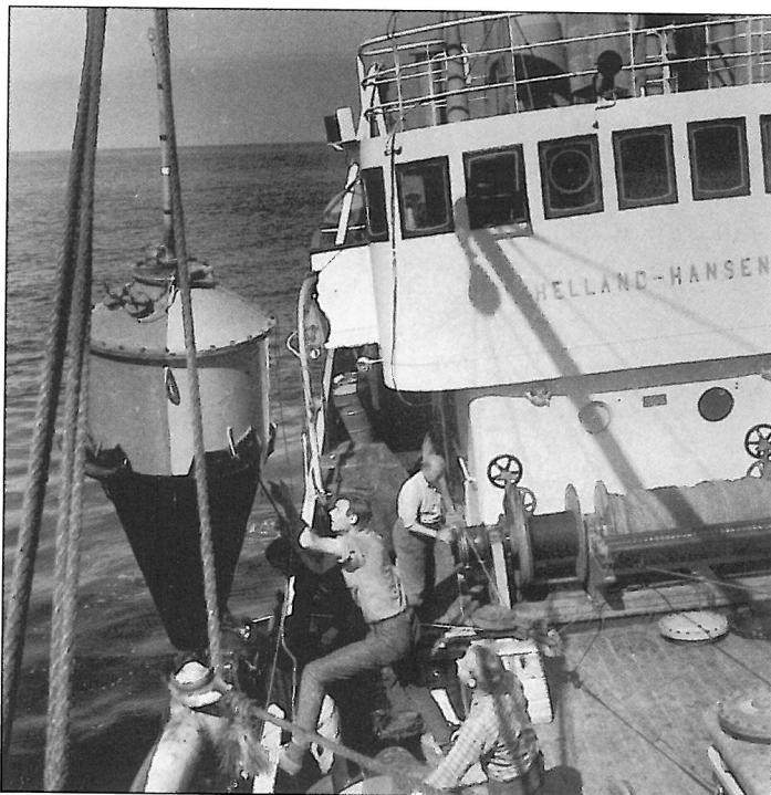
*Figur 2: Utsetjing av bøyen med elektronisk instrumentering, bl.a. lydbånddopptaker. Ein batterikasse (400 kg) er festa like under bøyen. Bøyen er ankra opp og ein kabel fører signala frå seismometer på havbotnen.*
