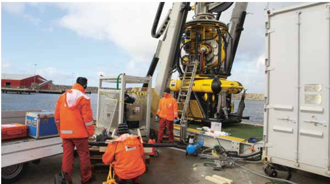
ROV gjøres klar for arbeid offshore. Foto: IKM Subsea
