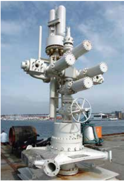
De fire ventiltrærne som produserte olje på havbunnen på Ekofisk i 1971 måtte betjenes manuelt av dykkere. Et av dem er bevart og står på kaien utenfor Norsk Oljemuseum. Foto: Norsk Oljemuseum
