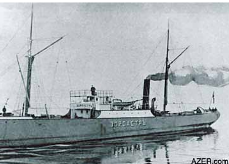
Zoroaster var verdens første tankskip, levert til Nobelbrødrene i Baku og satt i drift i 1878. Tankskipet var bygget av stål med oljetanker bygget av jern. Foto: Тёпшев/wikipedia.org
